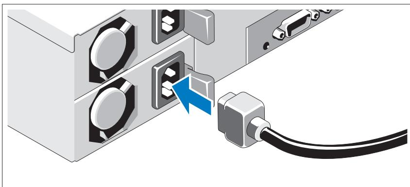
חבר את כבלי החשמל של המערכת למערכת, ואם אתה משתמש בציג, לחבר את כבל החשמל של הצג. לחבר את הקצה השני של כבלי החשמל לשוקע חשמל מואר או למקור מתח אחר, כגון מערכת אל-פסק (UPS) או יחידת חילוקת מתח (PDU).
