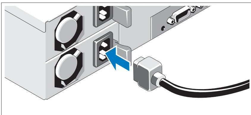
Подключите кабель (кабели) питания к системе. Если используется монитор, также подключите к нему кабель питания. Подключите другой конец шнуря питания к заземленной розетке илициальному источнику питания, например к источнику бесперебойного питания или блоку распределения питания.
