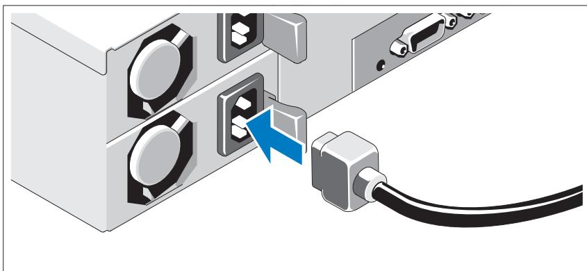
Podłącz odpowiednie kable zasilania do systemu oraz do monitora, o ile używasz monitora. Podłącz drugą końcówkę kabli do uziemionego gniazdka elektrycznego lub oddzielnego źródła zasilania, np. do zasilania bezprzerwowego (UPS) lub do jednostki rozdziału zasilania (PDU).
