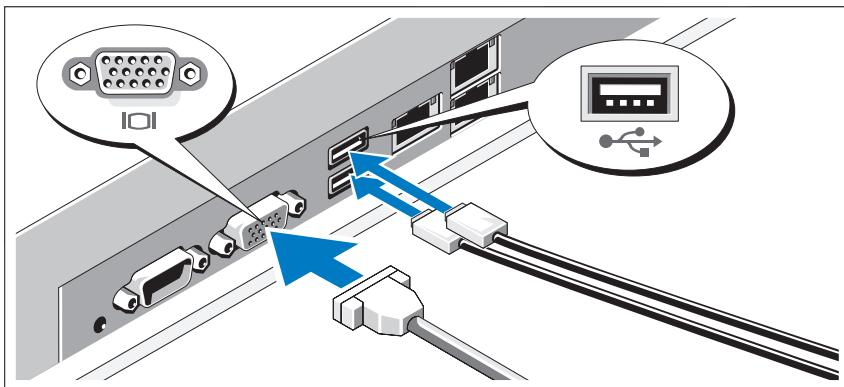
Подключите клавиатуру, мышь и монитор (дополнительно).
