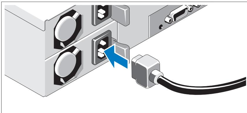
Conecte los cables de alimentación al sistema y, si se utiliza un monitor, conecte el cable de alimentación correspondiente al monitor. Conecte el otro extremo de los cables de alimentación a una toma eléctrica con conexión a tierra o a otra fuente de energía, como por ejemplo un sistema de alimentación ininterrumpida (SAI) o una unidad de distribución de alimentación (PDU).
